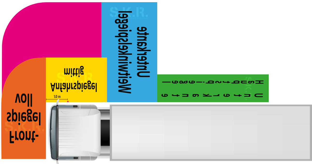
Grafik 01: Vollflächige Markierung mit spiegelverkehrten Schriftzügen. Anstatt der Schriftzüge können auch die Zahlen 1 - 4 bzw. 5 appliziert werden.
